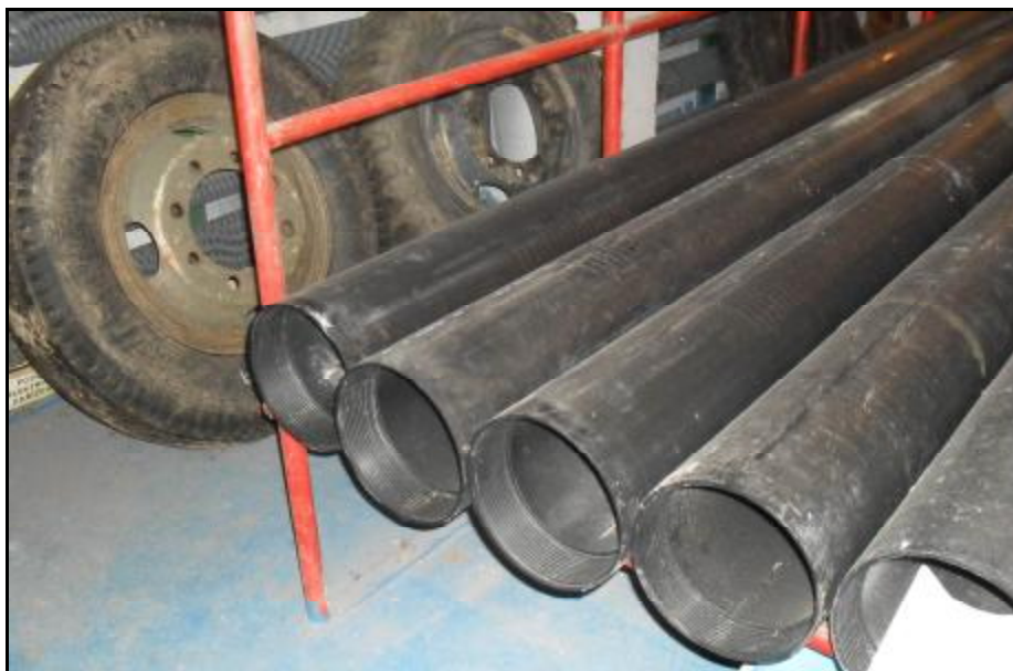
Foto 21 – Výstroj PE 225 mm (HV 1, HV 2, HV 3)
