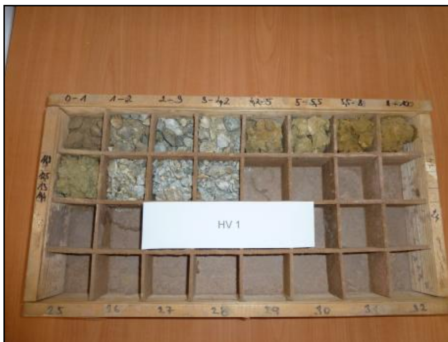
Foto 19 – HV 1 - odebrané vzorky vrtné drtě
