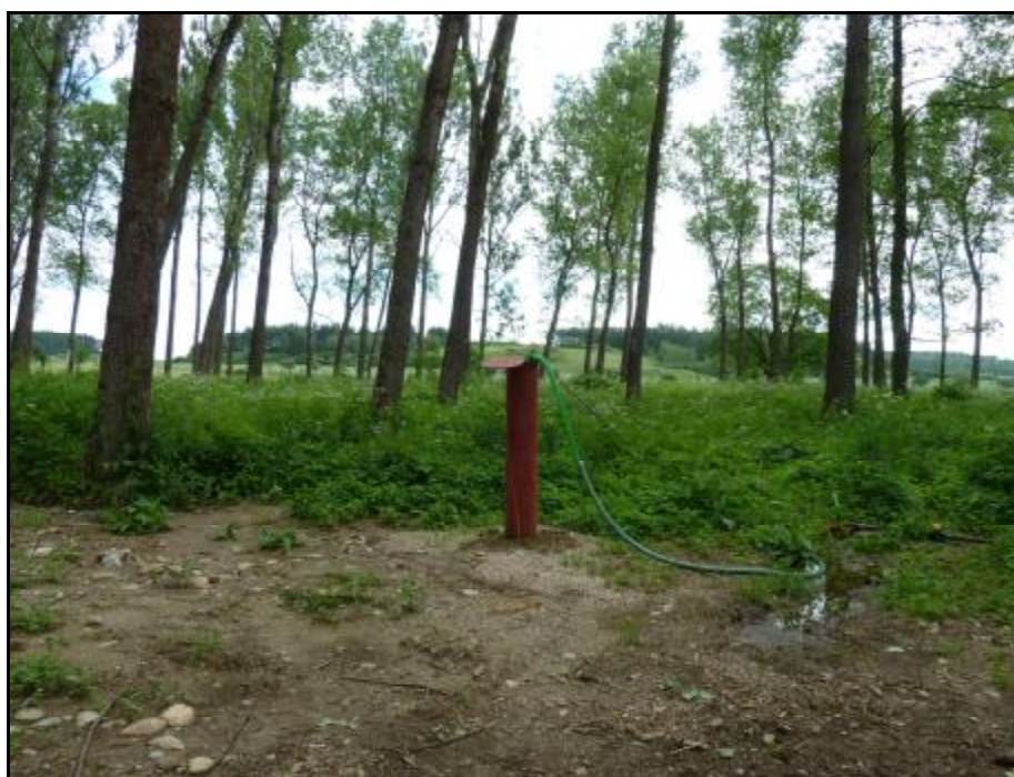
Foto 20 – HV 1 – v průběhu čerpací zkoušky
