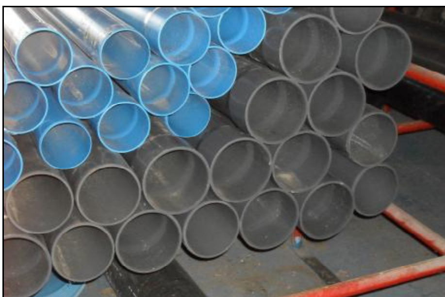
Foto 22 – Výstroj PVC 160 mm (HV 4)
