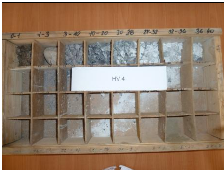
Foto 15 – HV 4 - odebrané vzorky vrtné drtě
